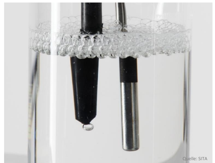
Abbildung 2: Eine kleine Luftblase an der Kapillarspitze dient als Grenzfläche zur Messung der dynamischen Oberflächenspannung.
