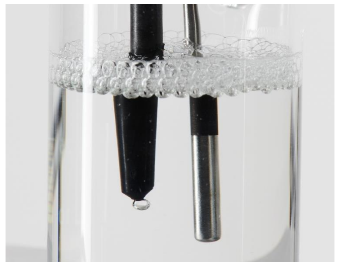
Abbildung 3: Eine kleine Luftblase an der Kapillarspitze dient als Grenzfläche zur Messung der dynamischen Oberflächenspannung.
