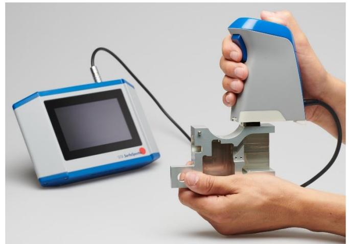
Bild 2: Mobiles Messgerät SITA SurfaSpector
