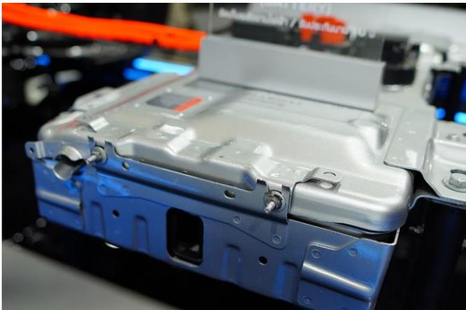
Bild 1: Batteriegehäuse aus Aluminium
